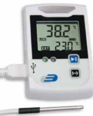
Beispiel LOG110 mit angeschlossenem externem Temperaturfühler (6040-0103)
