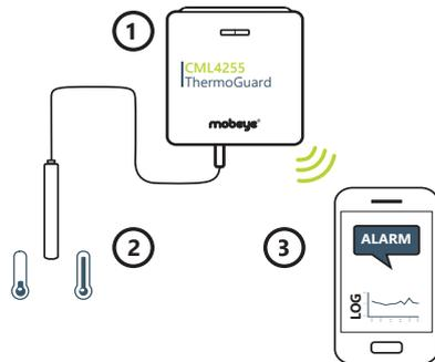
Der Mobeye CML4255 misst die Temperaturwerte kontinuierlich und protokolliert diese periodisch. So sind Sie umfassend über Alarmsituationen und kompletten Temperaturverlauf informiert.
